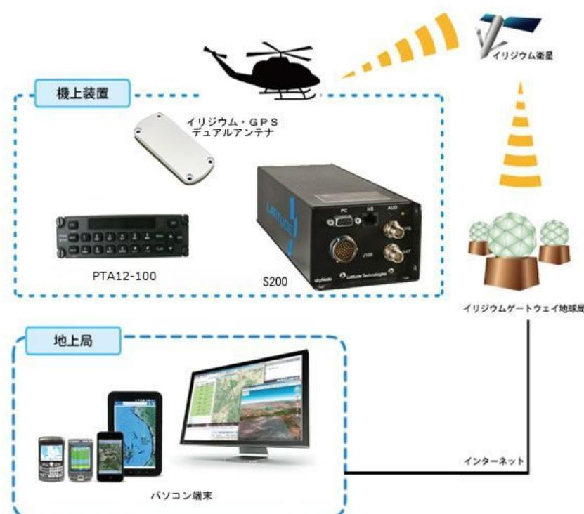
「搭載性向上型ヘリコプター動態管理システム」のシステム構成
